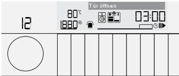
Falls der Wasserstand in der Maschine dies bei Betätigung der Start/Pause-Taste zulässt, erscheint „Tür öffnen“ im Display.
