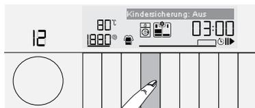
1. Zusatzfunktionstaste 1 3 Sekunden gedrückt halten. Nach Ablauf des Countdowns („Kindersicherung: Nach Ablauf des Countdowns („Kindersicherung: 3-2-1“) im Display wird „Kindersicherung deaktiviert“ angezeigt und die Kindersicherungsanzeige leuchtet auf.
