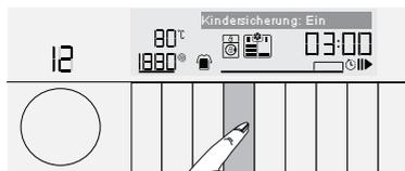
1. Zusatzfunktionstaste 1 3 Sekunden gedrückt halten. Nach Ablauf des Countdowns („Kindersicherung: 3-2-1“) im Display wird „Kindersicherung aktiviert“ angezeigt. Sie können Zusatzfunktionstaste 1 loslassen, wenn diese Warnung angezeigt wird.
