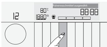
Wenn pulverförmiges Waschlittel in Programmen mit aktivem Waschlitteldosiersystem verwendet werden soll, sollte die erforderliche Menge pulverförmigen Waschlittels in das Waschlittelfach gegeben werden. Drücken Sie nach Auswahl von Programm, Temperatur, Schleudergeschwindigkeit, Zusatzfunktionen und Verschmutzungsgrad der Wäsche die Pulverwaschlittelaste. „Pulverwaschlittel ausgewählt“ wird angezeigt. Das Programm wird über die Start/Pause-Taste gestartet.
